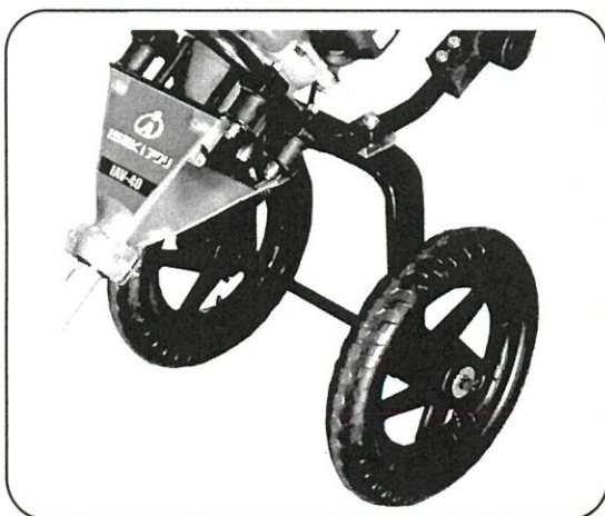
①車輪ステー外側への車輪取付
