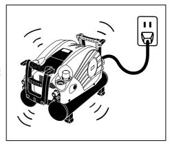
①冬場など外気温度が低い環境下で静音モード運転を開始すると空気が圧縮されない場合があります。このようなときは起動時に一定時間ハイパワーモード運転 (暖気運転)を行った後に静音モードに切替わります。
