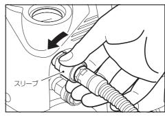
②エアチャックのスリーブを本機側に押し 込むことで取り外しできます。
