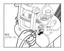
●本機にエアホースを接続する前に必ずエアホースとホース金具が完全に固定されている。 ことを確認する。
