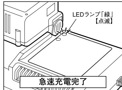
急速充電が完了したら使用できますが、そのまま電池パックを抜かないでおくと、残りの容量を充電し続け、LEDランプ「緑」が点灯（電子ブザーが「ピー」と約2秒鳴ります）になれば満充電完了（容量の100%）です。
