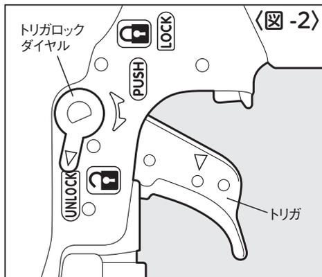
釘打作業を行う際はトリガロックダイヤルを押し回し、UNLOCK（アンロック）の位置にセットしてから作業を開始してください。
