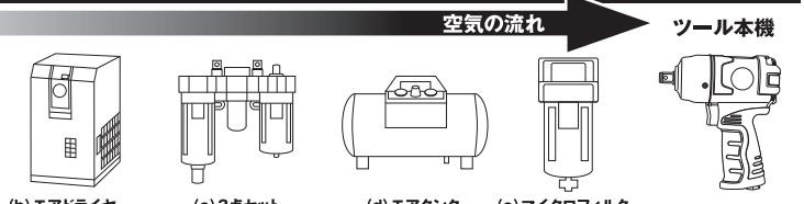
(a)エアコンプレッサー (b)エアドライヤー (c)3点セット (d)エアタンク (e)マイクロフィルター
