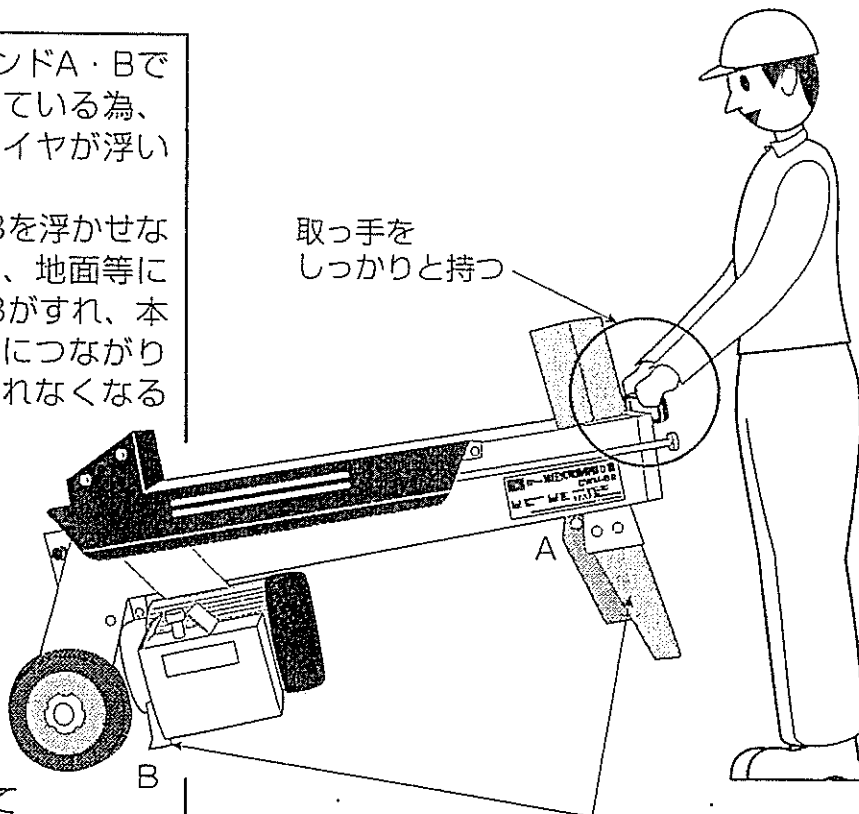
本体スタンドA・Bを地面から浮かせて移動する
