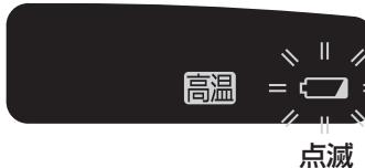
すぐに電池パックを充電してください。リチウムイオン電池は過放電状態になる(カラまで使う)と電池の寿命が大幅に劣化します。過放電防止のため、電池を保護する機能を搭載しております。
