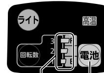
電池残量表示ランプ 電池残量表示ボタン
