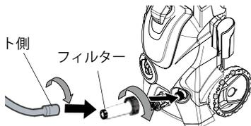
自吸用ホースの反対側の水を吸い込む黒い部品を図の方向に回して取り外します。
