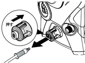
クイックカップリングを本体側に押しながら、高圧ホースを引き抜きます。
