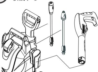
ノズルは本体背面のノズルホルダーに収納することができます。トリガーガンを、本体横のホルダーに差し込みます。
