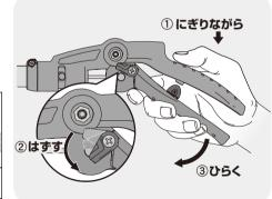
3 レバーと刃部は連動しますので、レ バーを開閉させ、刃が開閉するか確 認してください。
