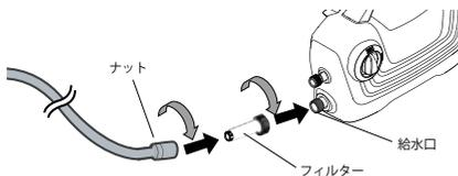
自吸用ホースの反対側の水を吸い込む黒い部品を図の方向に回して取り外します。
