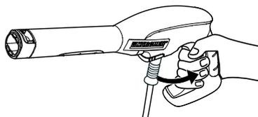
1 ジェットノズルを取り外し、トリガーガンのレバーを握って、ポンプの残留圧力と残水を抜いてください。
