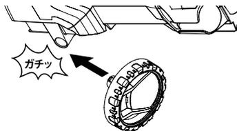
本体を横に倒し、タイヤを取り付けます。ガチッと音がするまでしっかりと押し込んでください。取り付け後、本体を起こします。
