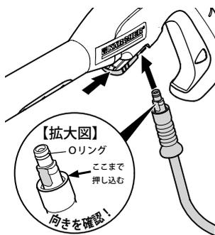
2. 高圧ホースの向きを確認して先端をトリガーガンにしっかりと押し込み、留め具をカチッと音が鳴るまではめ込んでください。
