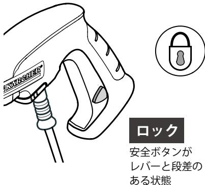
1 ジェットノズルを取り付け・取り外しの際は、トリガーガンの安全ボタンをロックし、誤作動を防止してください。
