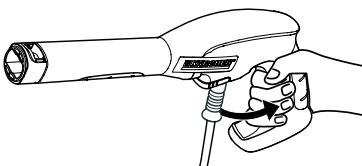
1 ジェットノズルを取り外し、トリガーガンのレバーを握って、ポンプの残留圧力を抜いてください。
