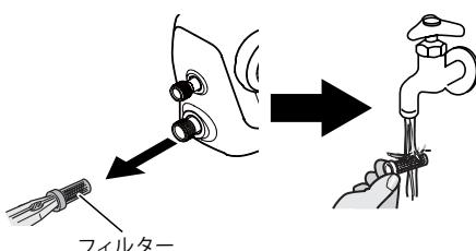
ペンチなどで給水口内部からフィルターを引き抜き、流水ですすぎ洗いをしてください。
