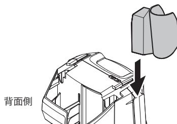
トリガーガンホルダーを本体に挿し込み、止まるまで下に押し込んで固定します。
