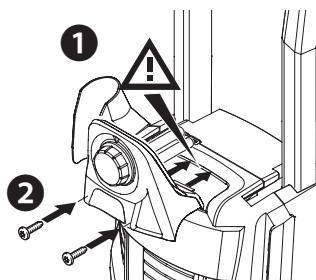
① 洗浄剤調節ダイヤルを本体に挿し込みます。
