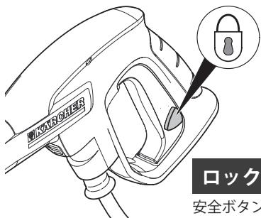
ノズルを取り付け・取り外しの際は、トリガーガンの安全ボタンをロックし、誤作動を防止してください。
