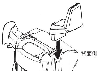
電源コードフックを本体に挿し込み下に押し込んで固定します。
