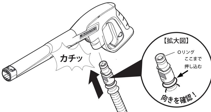
高圧ホースの向きを確認して先端をトリガーガンにしっかりと押し込み、カチッと音が鳴るまではめ込んでください。
