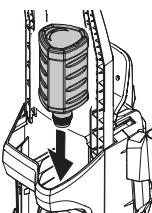
ユニバーサルクリーナーの灰色のキャップを持ち上げて外し、口を下にして洗浄剤タンクホルダーにセットしてください。
