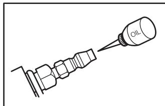
3. 取り付けたカプラーより、付属のオイルを0.5cc(2~3滴)位注入し、エアーホースにつなぎ3~5秒間試運転させオイルをなじませて下さい。
