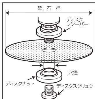
2. ディスクカバーが正しい位置に確実に取り付いているか、確認して下さい。そして、砥石径と穴径がそれぞれのツールに適合しているか確認して下さい。
