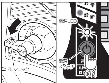
③モータが回転し、ドレンパイプの先端から空気が出ていることを確認してください。
