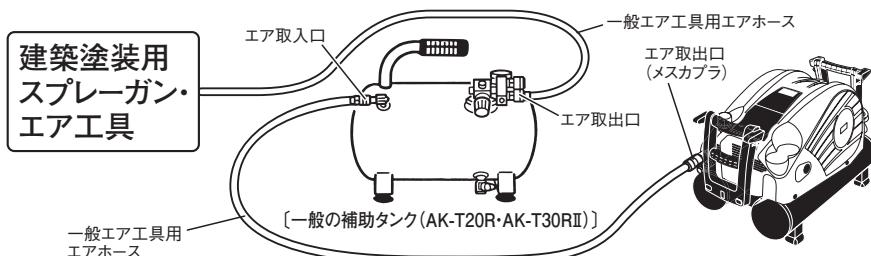
※マックス一般的補助タンク(AK-T20R・AK-T30RⅡ)のエア取入口・取出口は、エアチャックが装着されています。
