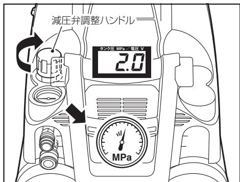
⑥ハイパワーモード運転の場合、6~7分程度で自動的に圧縮運転が停止することを確認してください。(ハイパワーモード以外での運転時、補助タンク接続時、電圧降下時は運転時間が変わる関係でこの場合は除きます。)
