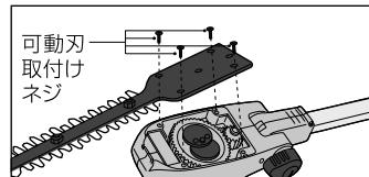
可動刃を本体と固定している4本のネジを緩め取外します。
