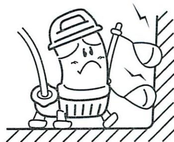
(2) 水槽に流れ込む水が直接フロートにかからないよう据え付けてください。
