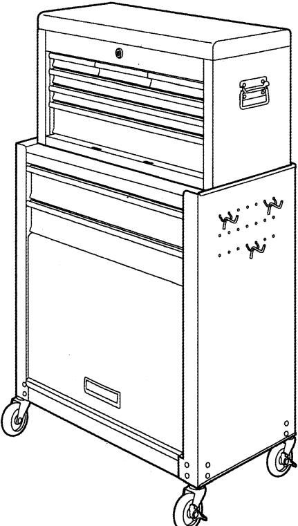
②使用時はトップカバーを開け、引出しストップバーを取り外して下さい。
