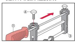
◆目立機をガイドバーに取り付けて、ヤスリがカッターの高さにくるように調節しながら、ロックネジ®で固定してください。
