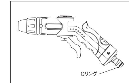
ガンやノズルの外観を目視し、亀裂や変形、損傷がないか点検してください。亀裂や変形、破損などの異常がある場合は、使用せず新しいものに交換してください。
