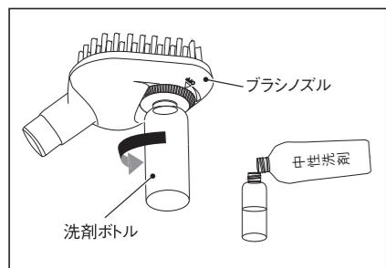
ブラシノズルから洗剤ボトルを反時計回りに回して洗剤ボトルを取り外し中性洗剤を入れます。
