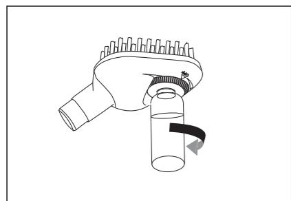
ブラシノズルを裏返し時計回りに回して洗浄ボトルを取り付けます。
