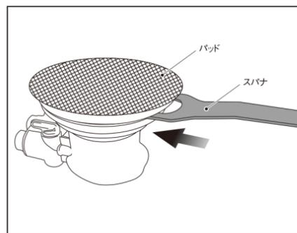
②軸の真ん中のナットにしっかりと固定しパッドを手で回します。
