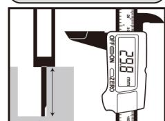
ディップスパー基準面を被測定物の基準面に真直ぐにてディップスパーのニゲのある側を内面にあわせ、奥まで真直ぐに差し込んで下さい。
