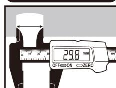
測定物を内側用のジョウを深く差しこみ内側用測定面を真直ぐに密着させて下さい。
