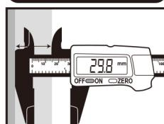
段差測定面をそれぞれ、被測定物の段差面に真直ぐに押しかけて測定して下さい。
