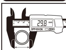
測定物を外側用測定面の中央で真直ぐに挟むようにして下さい。
