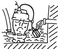
6. 起動・停止フロートを調整してください。(自動形のみ)
