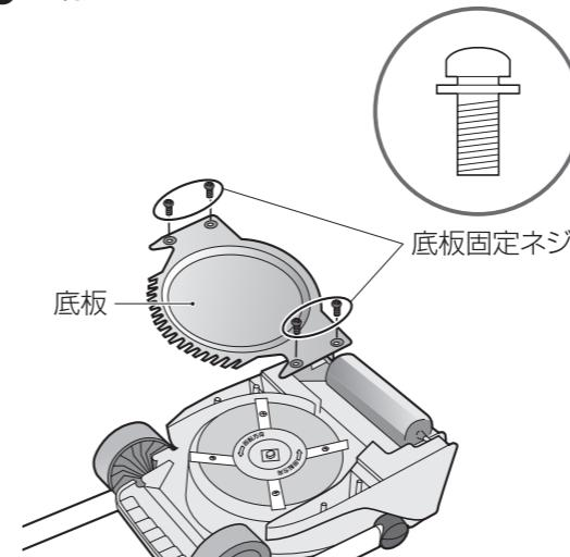
**4** ファンをしっかりと手で押さえながら $\oplus$ ドライバーでロータリー刃固定ネジをはずし、カッターロータリー刃(4枚)をはずしてください。
