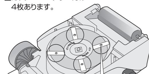
刃面の切り換え時、ネジ頭の $\oplus$ 溝部にゴミがつまり、掃除をしても $\oplus$ ドライバーで取りはずしにくい時は $\ominus$ ドライバーをご使用ください。
