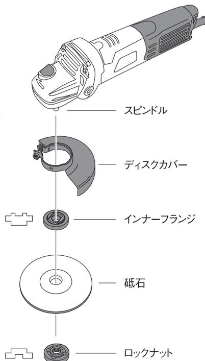
※締め付けゆるめは図を参照してください。
